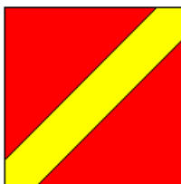
Fig. 3.2.6.5 Indicator stare necorespunzătoare a pistei
